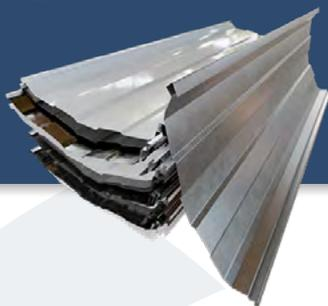
Lámina con sistema de engargolado Standing Seam Roof a base de clips para una unión hermética y libre de perforaciones. Su perfil trapezoidal propicia un óptimo retiro de aguas pluviales, mientras que sus acabados Zintro o Pintro le proporcionan una excelente resistencia a la corrosión.
